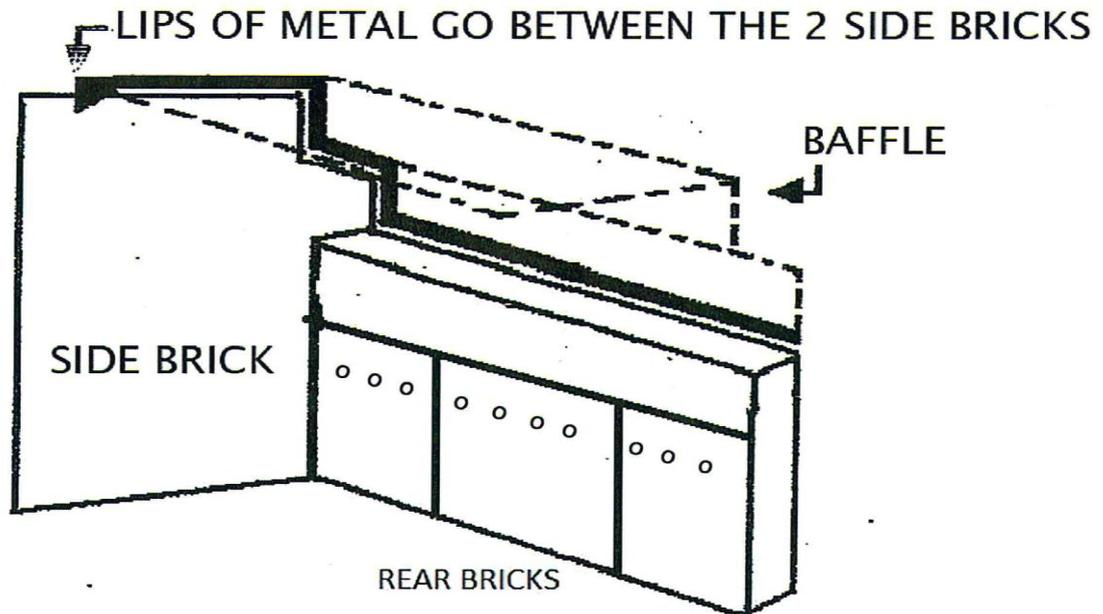
WHEN PUTTING THE BAFFLE INTO THE STOVE TAKE THE CASTLE OUT. THEN REMOVE THE RIGHT HAND SIDE BRICK
