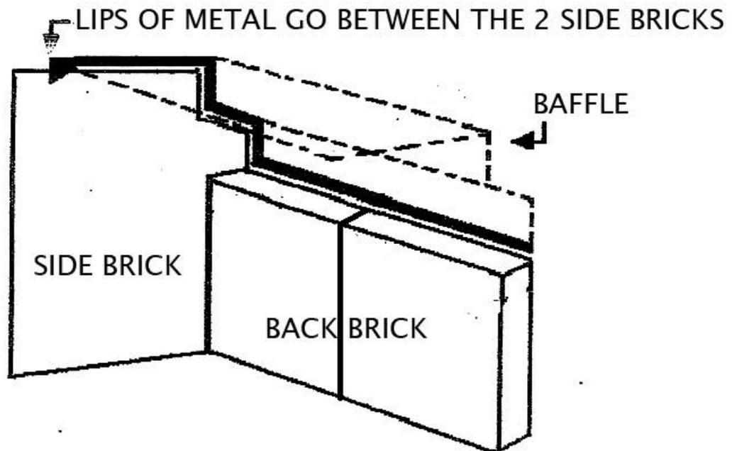
WHEN PUTTING THE BAFFLE INTO THE STOVE TAKE THE FUEL GUARD OUT.
