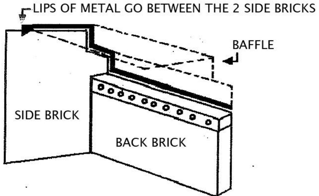
WHEN PUTTING THE BAFFLE INTO THE STOVE TAKE THE CASTLE OUT. THEN REMOVE THE RIGHT HAND SIDE BRICK
