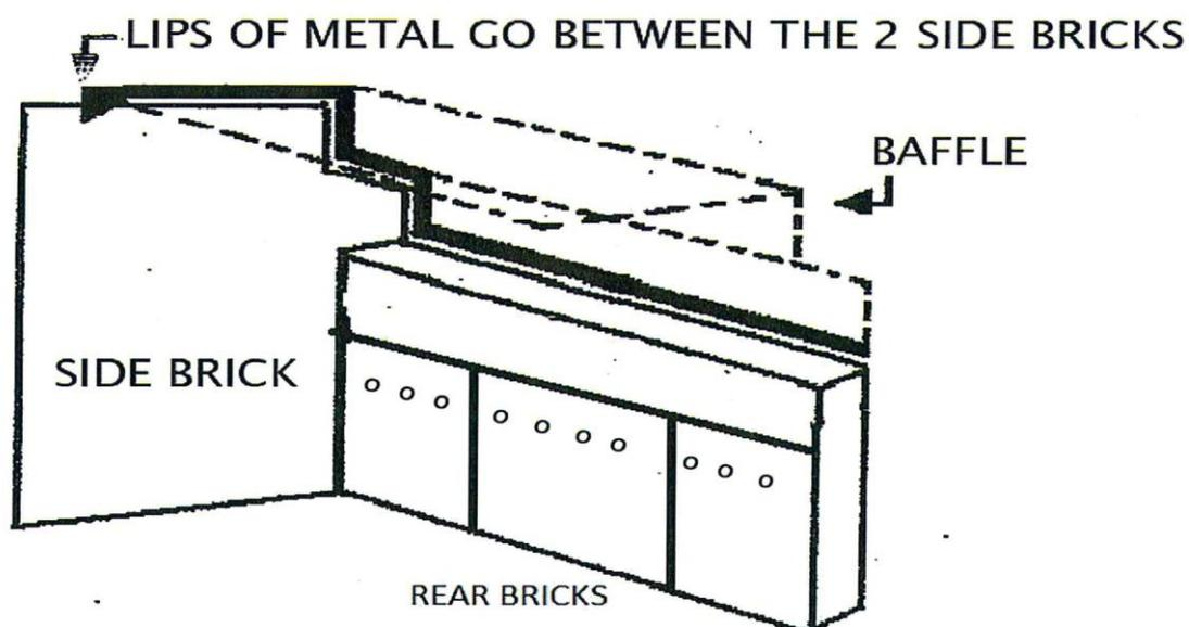
WHEN PUTTING THE BAFFLE INTO THE STOVE TAKE THE CASTLE OUT. THEN REMOVE THE RIGHT HAND SIDE BRICK
